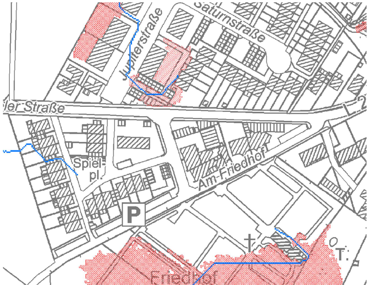
Abb. Starkregenrisikomanagement für die Stadt Troisdorf - Darstellung der „Fließwege als akkumuliertes Einzugsgebiet“ (blau) und „Mulden/Geländesenken“ (rot) im Umfeld des Plangebietes
