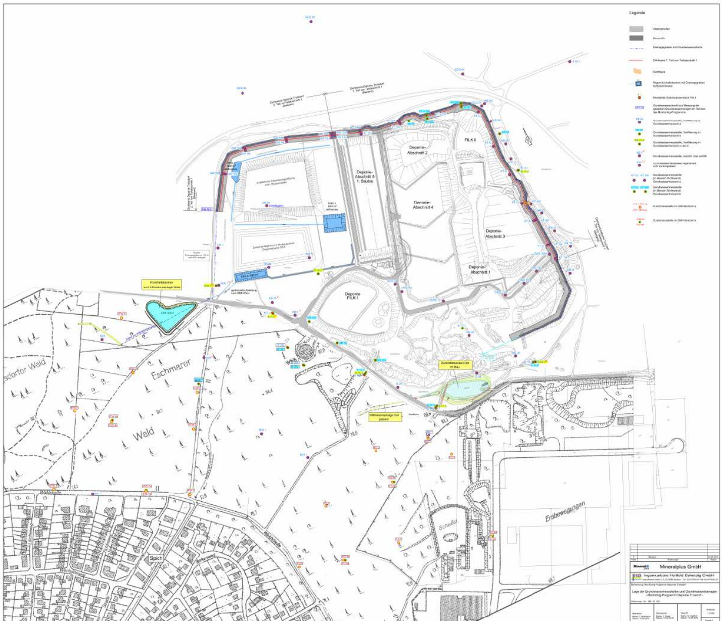
Karte 1: Lage der Grundwassermessstellen und Grundwasserdrainagen – Monitoring-Programm Deponie Troisdorf, Stand 15.04.2016.
